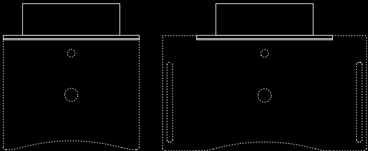
Il sistema brevettato Goman integra un mobile specchio con un meccanismo supporto lavabo, elettricamente movibile, per il sollevamento/abbassamento dell'insieme lavabo e specchio al fine di permettere il posizionamento ideale e a norma in funzione dell'utente (diversamente abili, anziani, bambini etc.).
